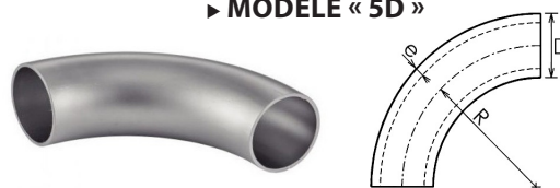
COUDE 90° ISO modèle « 5D » (ISO 5251) 316 L (autres sur demande)
