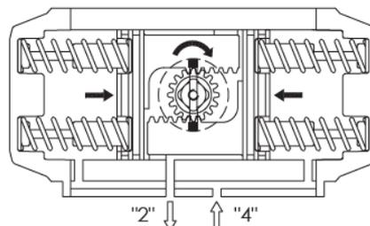
En cas de baisse de pression (manque d'air ou d'électricité) les ressorts ramènent les pistons dans leur position initiale ; l'air s'échappe par la sortie « 2 » ; une rotation dans le sens des aiguilles d'une montre est alors réalisée.
