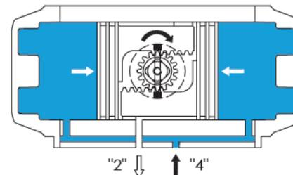
L'entrée d'air par l'orifice « 4 » repousse les pistons vers le centre et comprime la chambre centrale ; l'air présent y est évacué par l'orifice « 2 ». Une rotation dans le sens des aiguilles d'une montre est réalisée et l'actionneur revient à sa position initiale.
