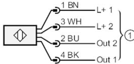
1 : raccordement aux amplificateurs NAMUR
