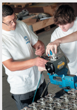
Atelier de montage et motorisation de vannes
