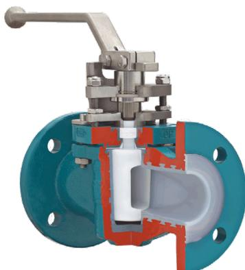
Le principe du **robinet à tournant conique** repose sur un tournant (cône mâle) percé d'une lumière, contenu dans le corps de la vanne (cône femelle).
